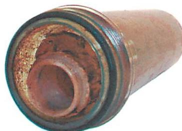
Hier soll Trinkwasser gefiltert werden? Verschmutzte Filter stellen ein großes Hygienierisiko dar!
